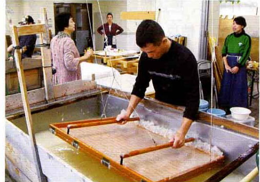
職人の手で漉いている様子(写真提供:美濃手すき和紙協同組合)
